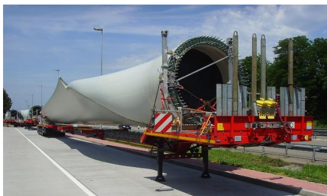
Strassentransport eines Rotorblattes
